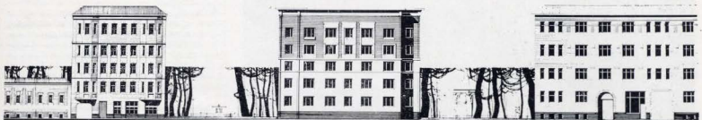
Фасад дома П3/5HMKT. [применены детали сокращенной номенклатуры]
