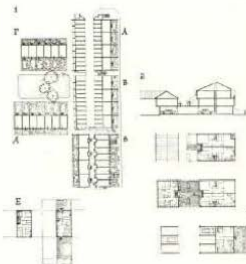
Жилая группа из двух- и трехэтажных блокированных домов на 68 квартир со встроенными гаражами и пешеходной платформой на уровне второго этажа
