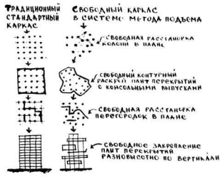
Схемы свободного каркаса при сооружении зданий методом подъяема
