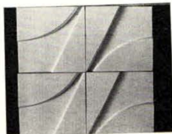
Образцы рельефной бетонной плитки для облицовки жилых домов
