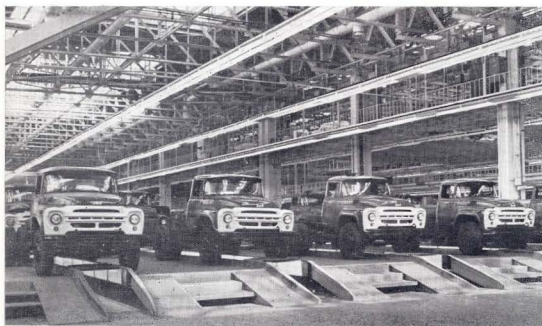
Автоборочный корпус. Пролет отделочно-го конвейера
