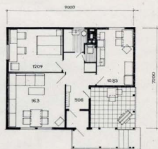
Одноэтажный одноквартирный двухкомнатный жилой дом. Гипролеспром Общий вид и план
