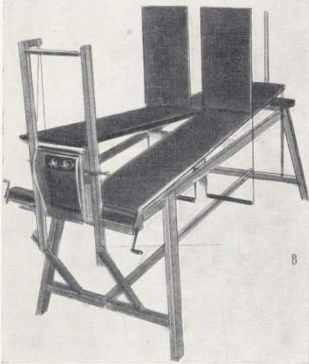
Специальные приборы из архитектурной лаборатории ВХУТЕИНа: А — для определения пространственных свойств формы [«прострометр»]; Б — для сравнения плоскостных фигур [«плотгонометр»]; В) для сравнения объемных построений [«коглометр»]
