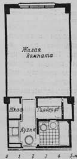
План однокомнатной квартиры с кухней-шкафом в передней (США)
