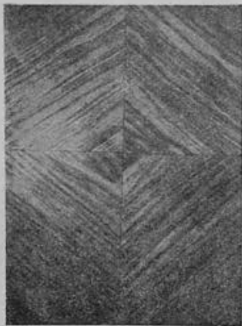
Подбор из 4 фанер в стык, с диагональным расположением волокон. Порода—орех грецкий
