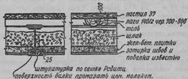
Перекрытие на металлических балках
