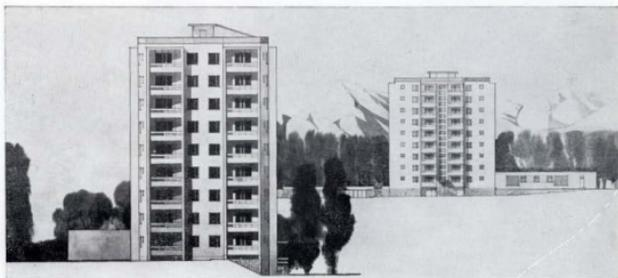
Проект 9-этажного жилого дома из монолитного железобетона в скользящей опалубке. Архитектор Г. Герпогосов, инженеры П. Медников, Г. Белоусова
